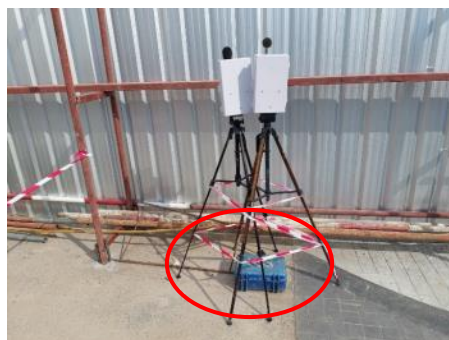
รูปที่ 3.17 การตรวจวัดความสั่นสะเทือนภายในพื้นที่โครงการ
